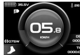
按住▼键，脚跳动，车辆以不大于 6Km/h 的速度行驶。释放▼键，功能撤销。
