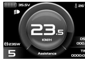
短按▲或▼键，切换 0-5 档（N 为 0 档）。1 档最低功率档，5 档最高功率档。每次开机，自动恢复上次关机时的档位（用户可另行设置）。0 档无助力转把功能。
