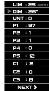
进入参数界面，光标移至轮径DIM，短按 键，数值闪烁，进入DIM参数设置状态。短按 和 键，设定轮径规格。选择范围5、6、8、10、12、14、16、18、20、23、24、26、27.5、700C、28和29英寸。短按 键，停止闪烁并保存设置。
