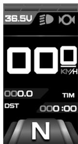
长按键，开机；再长按键，关机。当车辆停止行驶且连续5分钟未对仪表实施操作，仪表将自动关机。
