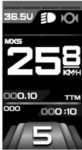
在显示界面二，短按 键，进入显示界面三单次最高速度(MXS)。在骑行状态下，3秒后，单次最高速度(MXS)显示自动返回至显示界面一。
